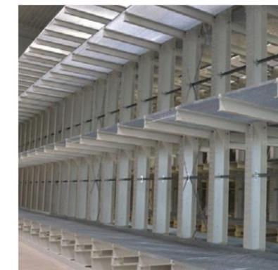
Kragarme mit Gitterrostauflagen für besonders schwere Lasten.
