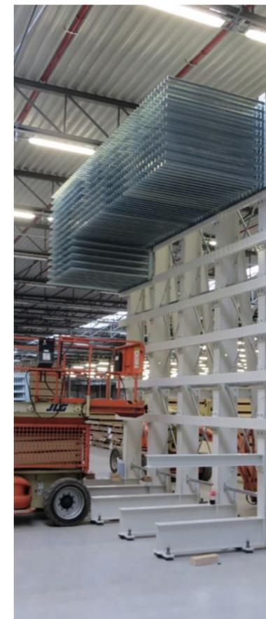
Kragarmkämme für Einzelplattenlagerung.
